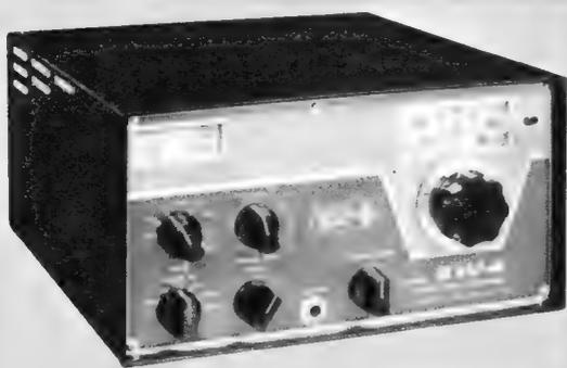
Links: Bild 1. Spezialempfänger für KW-Rundfunkhörer Drake SW-4
