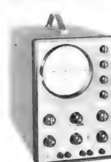
Universal-Oszillograph mit 3stufigem Gegentakt-Gleichspannungs-Verstärker großer Empfindlichkeit. Kompensierter 4stufiger Abschwächer, 12,5 cm Kathodenstrahlröhre, direkte Anschlußmöglichkeit der Vertikalplatten, Rücklaufaus-tastung und Synchronisationswählschalter, Rechteckgleichspannung. Lochblechgehäuse grau mit Frontrahmen. Technische Daten: Vertikal: 3,5 mV/aff cm, 0-500 kHz
