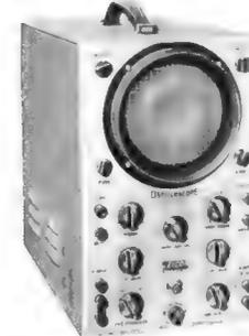
12,5-cm-Bildröhre mit Flutlichtstrahler und kontinuierlicher Helligkeitsregelung, Strahlverschiebung horizontal und vertikal, Rücklaufaus-tastung, Helligkeitsmodulationsanschluß, Eichspannung, 50 Hz und Sägezahnanschl. Technische Daten: Vertikal: Gleichspannungs-Gegentaktverstärker 0-5 MHz (verwendbar bis 10 MHz) 10 mV/cm, 4fach Frequenzkomp.
